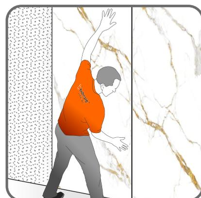
6-Verifique na instalação nivelamento e certifique-se o encaixe da textura.
