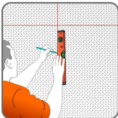
4-Para garantir uma instalação perfeita use nível ou laser autonivelantes.
